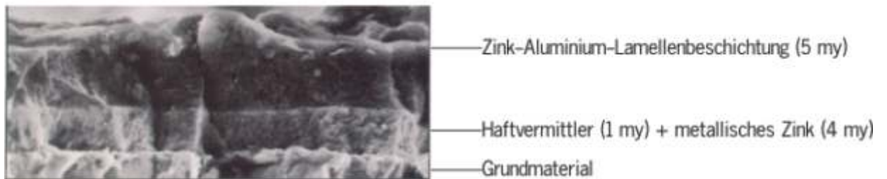
Querschnitt in 1000-facher Vergrößerung
